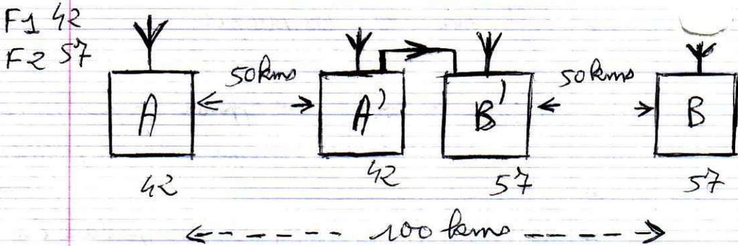
Ce montage permet la transmission soit sur une fréquence soit sur deux fréquences, ( $F_1, F_2$ )
